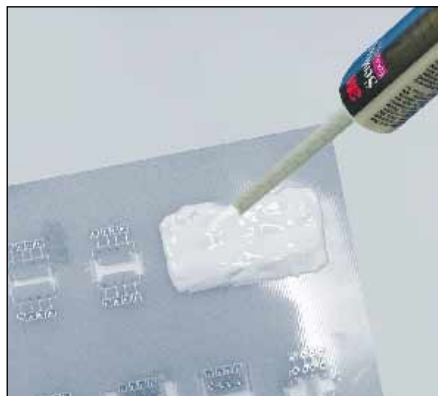
Verkapseln von Microchips auf Pay TV Decodern zum Schutz vor Hackern 3M Scotch-Weld DP 760
