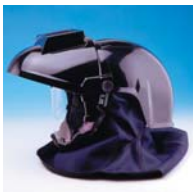
3M HT-748 Casque à visière en polycarbonate avec protection antiéblouissante rabattable pour soudure. (90 x 110 mm) EN166 2:B:3:9 EN397 BS1542 classe 4
