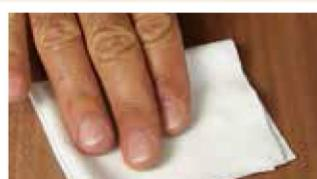
**5) Entfetten:** Mit dem Baumwolltuch leicht über Schadensumfeld und befüllte Stelle wischen und somit die ganze Fläche entfetten.
