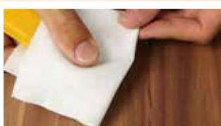
**4) Umfeld säubern:** Baumwolltuch straff über den Füllstoff-Hobel spannen und unter leichtem Druck das Wachs im Umfeld entfernen.
