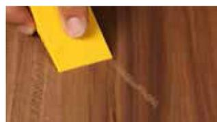
**2) Plan arbeiten:** Mit der abgeschrägten Kante des Füllstoff-Hobels das aufgebraute Wachs unter leichtem Druck in kreisenden Bewegungen verreiben.
