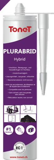
Mastic d'étanchéité monocomposant universel, élastique et à forte adhérence, à base de SMP, pour l'intérieur et l'extérieur, sur des supports lisses et poreux. Absolument résistant aux intempéries, durcissant à l'humidité, exempt de silicone, à réticulation neutre et à très faibles émissions.
